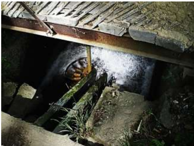
Bild 22: Waagrecht liegendes Schaufelrad zur Aufnahme der Wasserkraft
